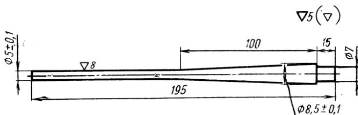
4.4. Технологическая проба волочением должна производиться путем волочения образцов на стане однократного волочения или разрывной машине через фильтру с углом рабочего конуса 15—25° и диаметром калибрующего пояска  $5 \pm 0,2$  мм до разрыва в цилиндрической части, после чего производят замер протянутой части образца.
